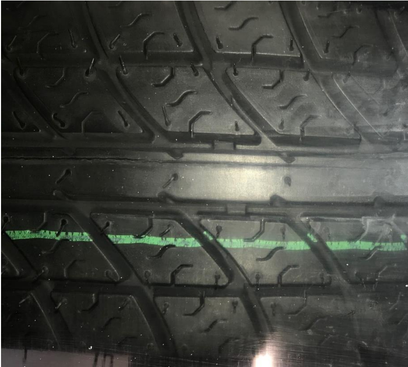
Abbildung 2 Aufnahme des laufenden Reifens durch die Glastrommel
